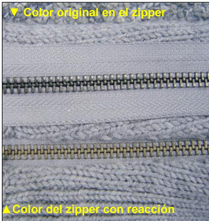
Elementos oxidados del zipper metálico debido a ácido sulfúrico residual en las telas de lana.
