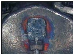
Daño en la corredera: debido a la disolución de la aleación de zinc bajo tratamientos químicos fuertes en los procesos húmedos de las prendas.
