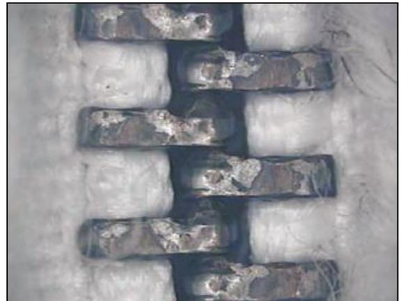
Cambio de acabado en los elementos del zipper metálico debido a la influencia de ácido sulfúrico en las prendas de lana.
